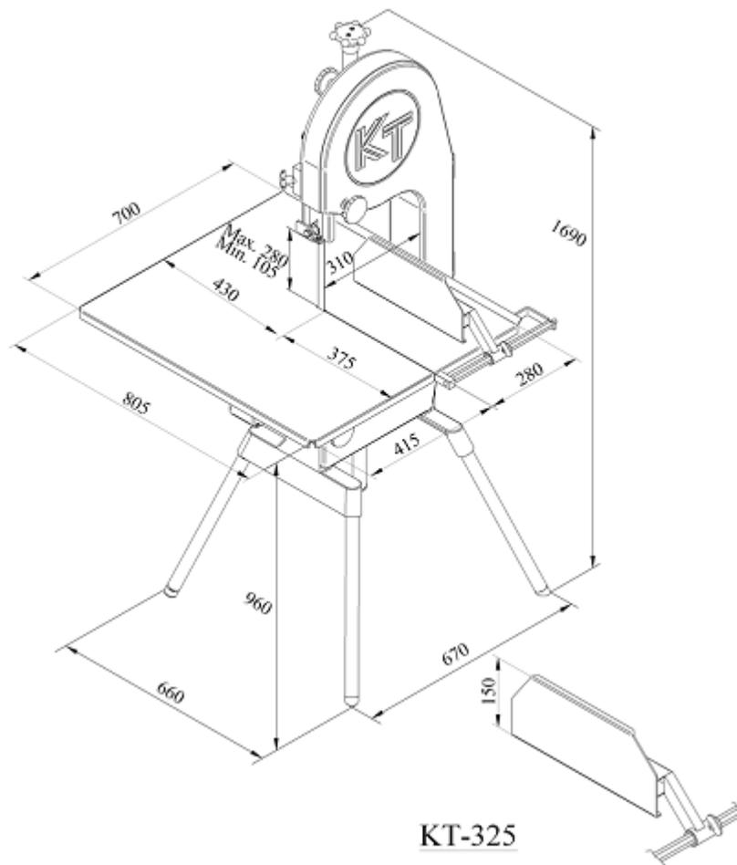
**Ленточная пила КТ-325 с фиксированным столиком**
