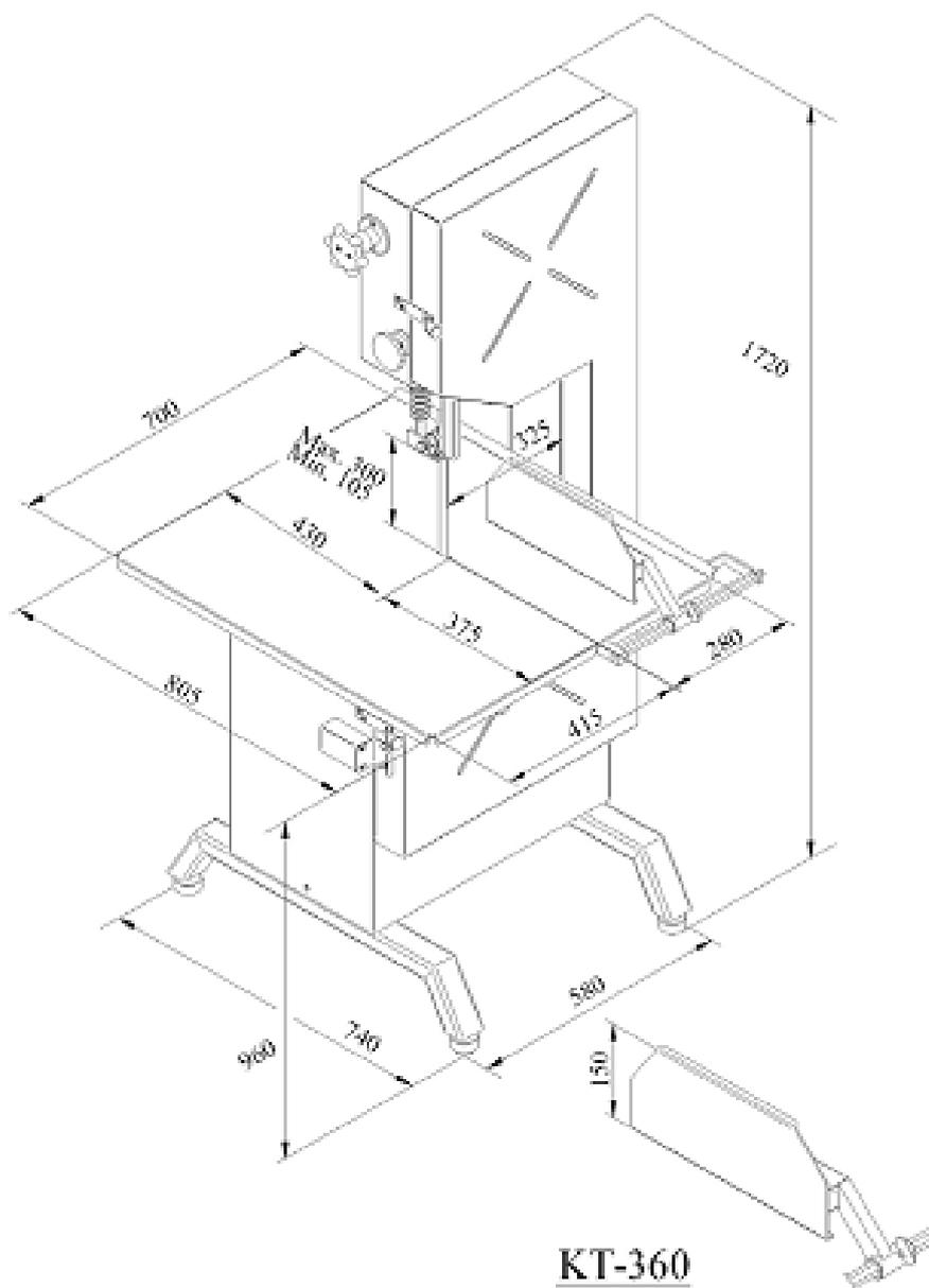
**Ленточная пила КТ-360 с фиксированным столиком**
