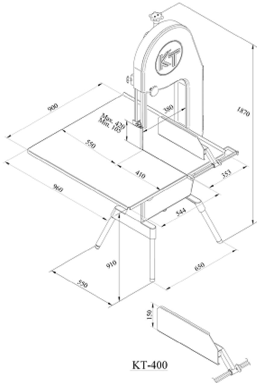
**Ленточная пила КТ-400 с фиксированным столиком**
