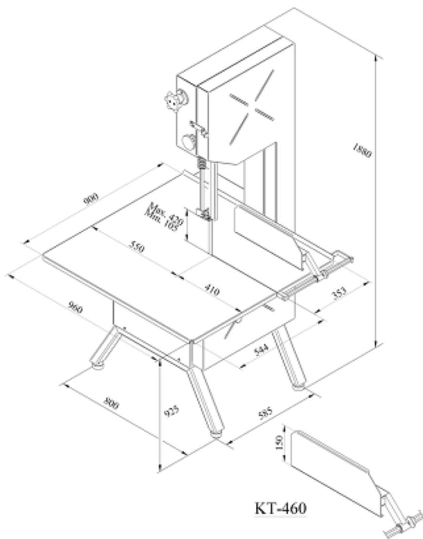
**Ленточная пила КТ-460 с фиксированным столиком**
