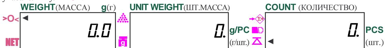
Если взвешиваемый груз имеет слишком малую массу, меньше  $10 d$ , после его взвешивания на дисплее **UNIT WEIGHT** (ШТ.МАССА) включится указатель . На процедуре взвешивания это конкретно не сказывается, но в счетном режиме его включение информирует оператора, что дальнейшее измерение штучной массы приведет к слишком большой относительной ошибке в результате счета.
