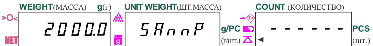
а затем – окончательный объем пробы на дисплее **COUNT** (КОЛИЧЕСТВО), здесь 50 шт., и на дисплее **UNIT WEIGHT** (ШТ.МАССА) соответствующее ему значение штучной массы, здесь 40 г/шт, в форме 6-разрядного числа
