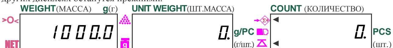
□ Уберите первый груз с платформы (показание на дисплее WEIGHT (MACCA) обнулится) и положите второй взвешиваемый груз на платформу. Указатель нуля >O< выключится, а стабильности  $\Delta$  - сначала выключится, а затем включится вновь. На дисплее WEIGHT (MACCA) высветится показание массы груза (здесь: 3000,0 г).
