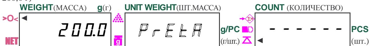
□ и нажмите клавишу **TARE**. На дисплее **WEIGHT** (МАССА) высветится введенная масса тары со знаком минус и включится указатель **NET**, а на дисплее **UNIT WEIGHT** (ШТ. МАССА) высветится нулевое показание.
