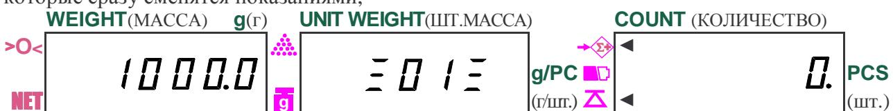
высвечиваемыми в течение ~ 3 сек (указатель суммирования  $\Sigma$  будет включен). Здесь на дисплее UNIT WEIGHT (ШТ.МАССА) высвечивается порядковый номер взвешивания, а именно № 1. Затем показание на дисплее UNIT WEIGHT (ШТ.МАССА) обнулится, а на других дисплеях останутся прежними.
