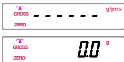
В заключение на дисплее устанавливается режим взвешивания с нулевым показанием и включаются указатели **ZERO**, **GROSS**, **g** и стабилизации **▲**.
