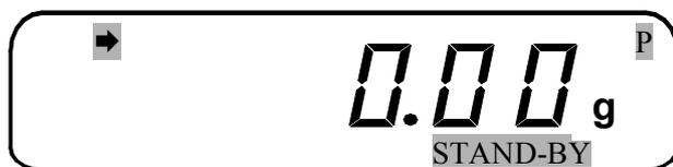
Нажмите клавишу **PRINT**. Указатель **STAND-BY** выключится, и начнет действовать функция измерения пиковой нагрузки.
