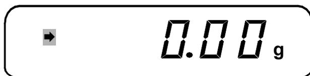
Положите на платформу первый взвешиваемый груз. После стабилизации результат измерения высвечивается на дисплее и передается на печать (во время передачи на дисплее кратковременно высвечивается указатель
