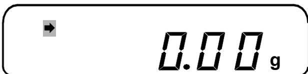
☐ Повторяйте последние два действия для всех компонент смеси. Закончив взвешивание всех компонент, уберите весь груз с платформы вместе с тарой. Будет показана масса брутто всей смеси со знаком минус (здесь – 300 г).
