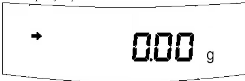
❑ В случае дрейфа показаний при пустой платформе нажмите перед измерением клавишу обнуления **0/T**.
