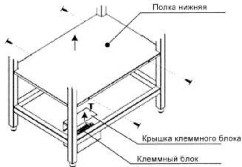
Рис. 10 Подключение электропитания плиты ЭПК-48П
