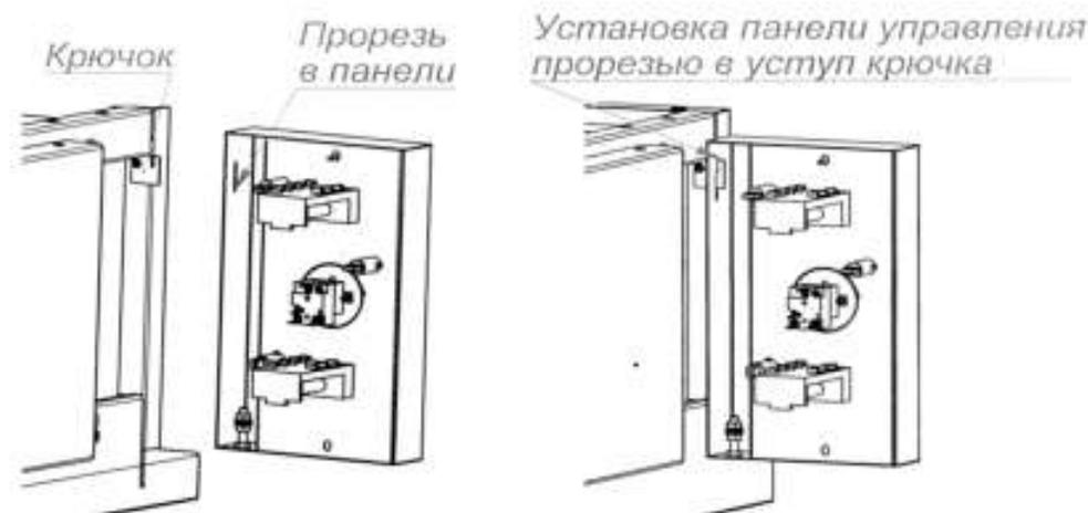
Рис. 11 СХЕМА УСТАНОВКИ ПАНЕЛИ УПРАВЛЕНИЯ ПРИ ТО
