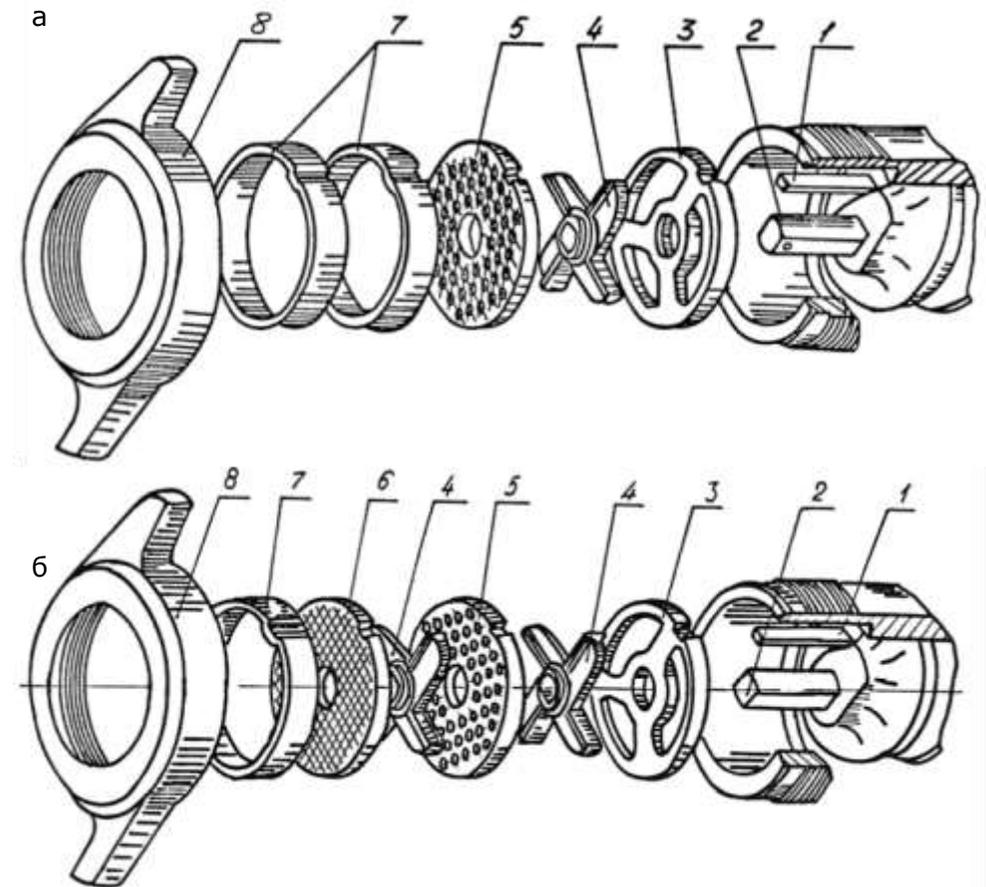
1- Шпонка; 2- Шнек; 3- Нож подрезной; 4- Нож двусторонний; 5- Решётка с отверстиями 9мм;
