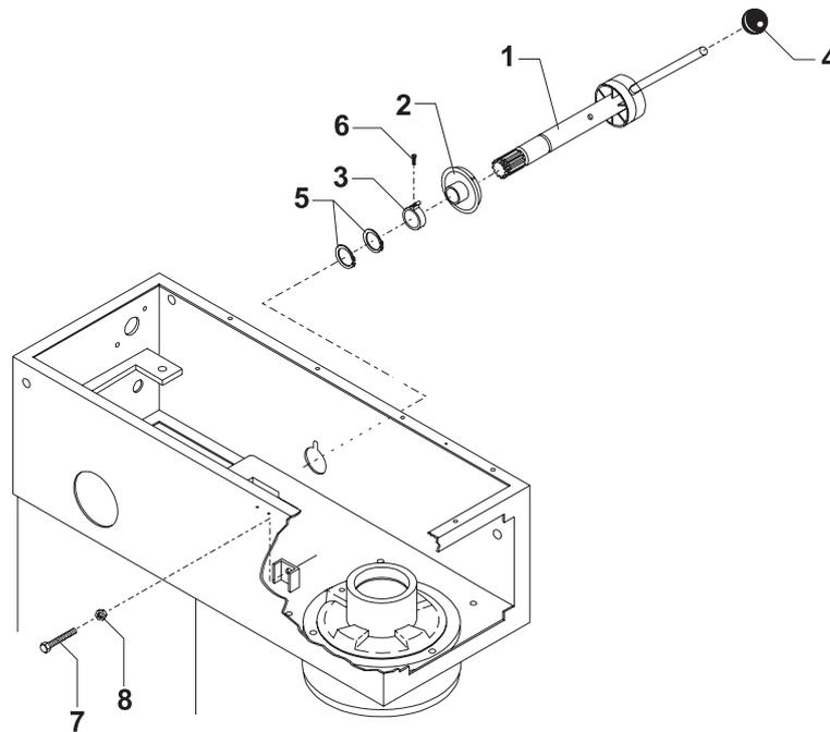
AR31-47Z..... reguleringsarm for hastighed kompl. .... speed selector lever, assy. .... regulierungsarm für geschw.keit kompl.
