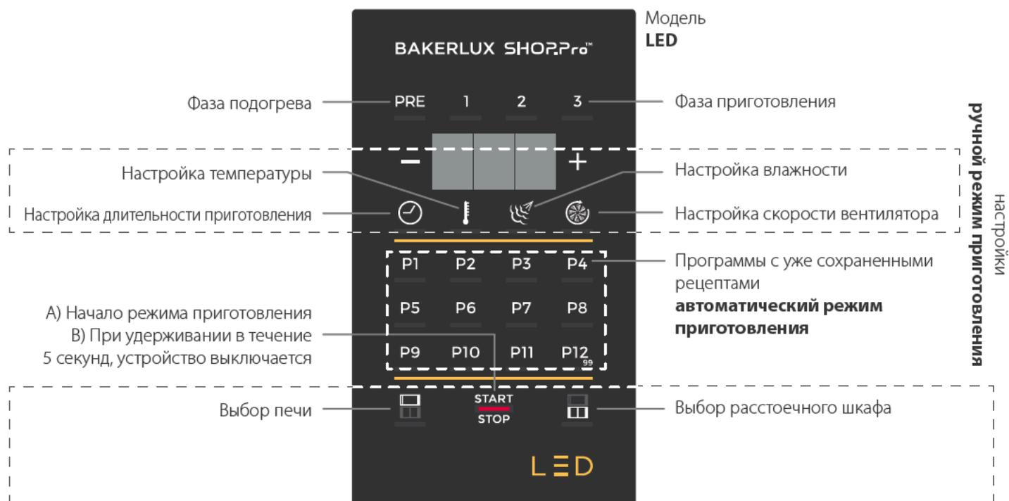
В моделях "LED" можно осуществлять контроль как за печью, так и за подсоединенным к ней расстоечным шкафом, путем воздействия на единую панель управления.
