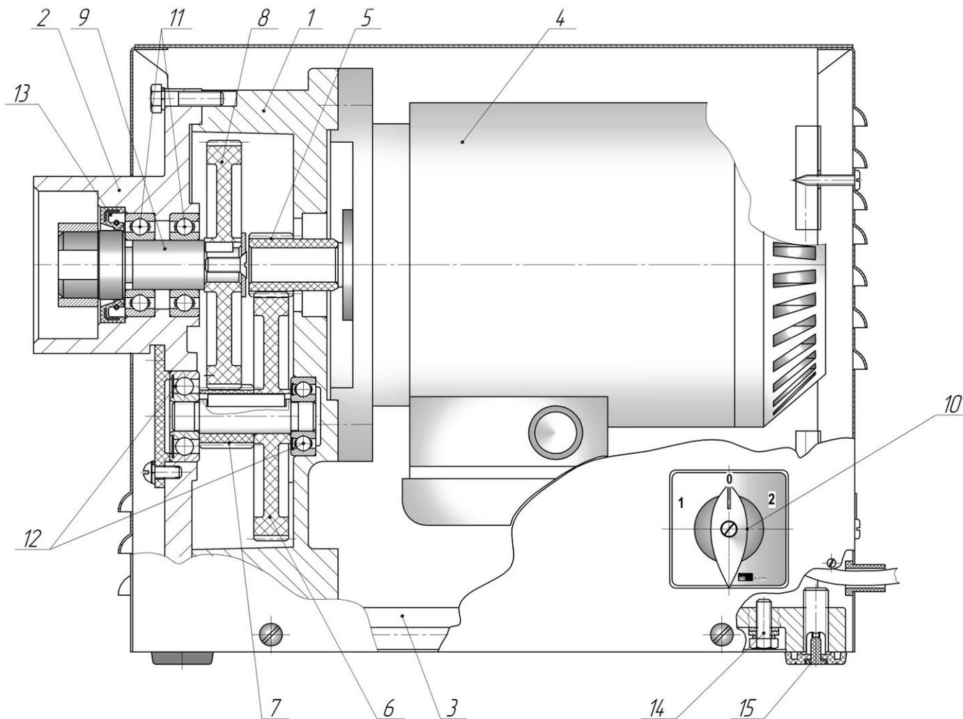
**Рисунок 2 – Приводной механизм**
