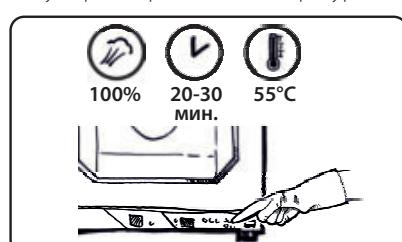
7. Отключите режим пара, выключите нагрев, откройте дверь и тщательно промойте душем.
