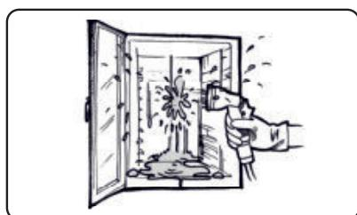
4. Обильно нанесите очиститель на внутренние поверхности пароконвектомата.
