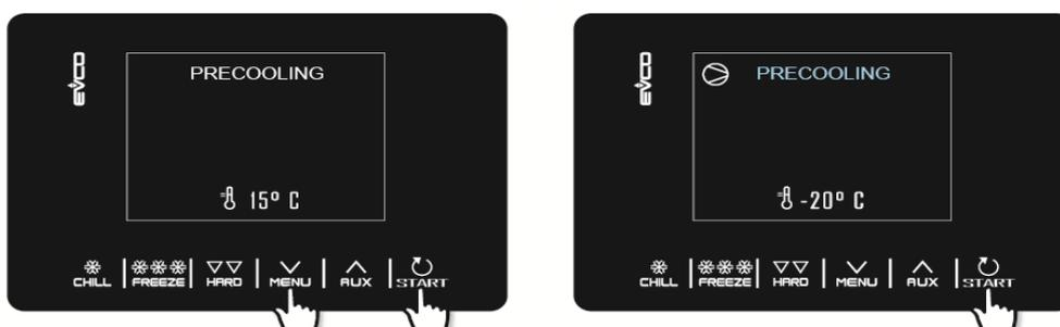
Как только будет достигнута требуемая рабочая установка температуры камеры, будет подан звуковой сигнал и цикл будет поддерживать достигнутую температуру камеры до тех пор, пока не будет в течение 2 секунд удерживаться нажатой кнопка
