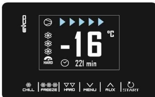
По завершении цикла шокового охлаждения / шоковой заморозки, когда температура игольчатого зонда достигнет правильного значения, либо завершится период времени, будет подан звуковой сигнал и начнется фаза консервации. Если цикл, управляемый по температуре не завершится в отведенное время, на дисплее появится оповещающее об этой проблеме сообщение тревоги.
