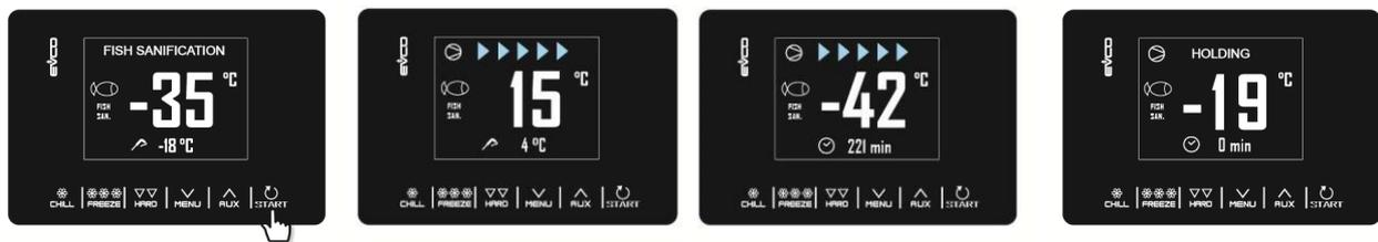
В течение цикла санитарной обработки рыбы, прибор всегда будет показывать температуру камеры и, в зависимости от выполняемой фазы, температуру окончания шокового охлаждения или продолжительность фазы поддержания.
