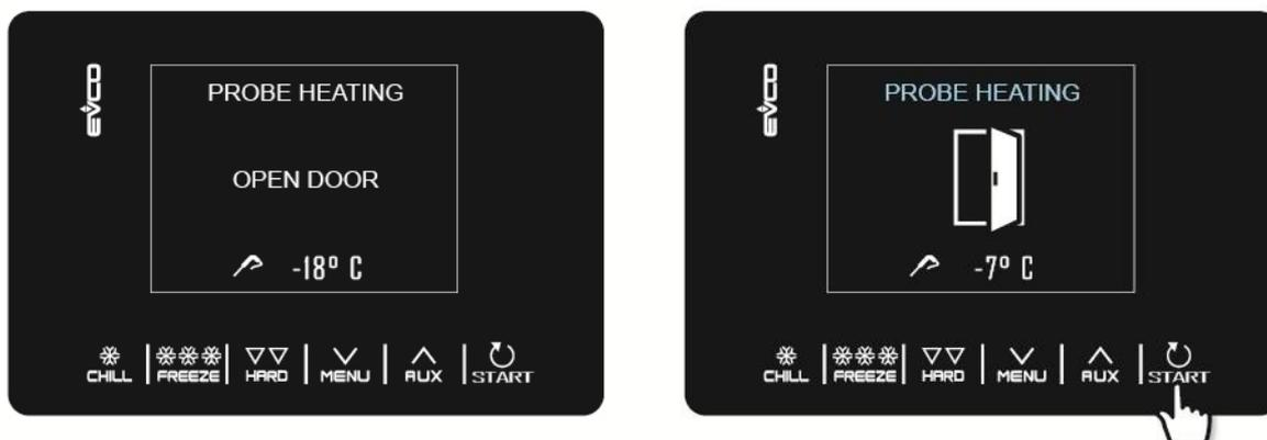
Выход нагревания игольчатого зонда активирован в течение интервала времени, заданного параметром u8 или до тех пор, пока температура, регистрируемая игольчатым зондом не достигнет той, что задана параметром u7. В конце цикла раздастся звуковой сигнал и на экране вновь появится окно Home (Главное меню).
