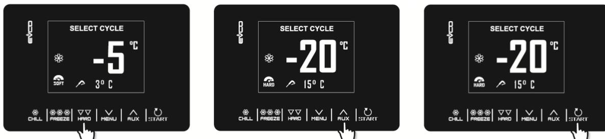
Пример цикла шокового охлаждения с управлением по температуре (с игольчатым зондом), - добавление жесткой фазы, быстрая смена рабочей установки камеры для мягкой фазы и запуск цикла.
