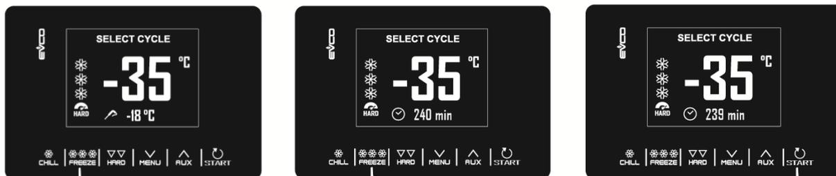
Пример цикла шоковой заморозки, управляемого по температуре (с игольчатым зондом) - преобразование в цикл с управлением по времени, быстрое изменение длительности цикла шоковой заморозки и запуск цикла.
