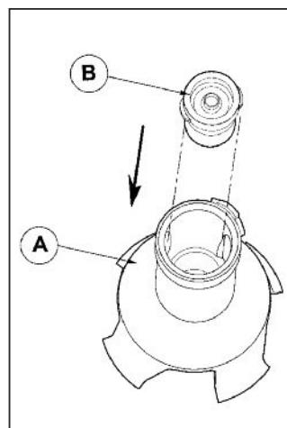
Установите проушины уплотнительного блока ® бровень с канавками насадки ®. Поверните уплотнительный блок рукой в направлении, указанном стрелкой, а затем закрепите его на насадке с помощью инструмента для снятия ножа.
