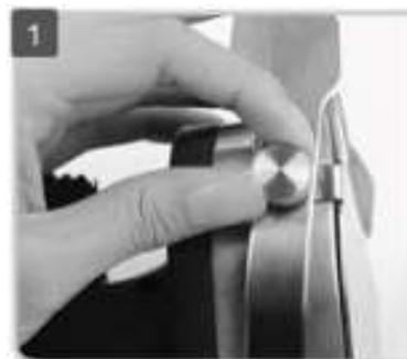
**Снимите стопорный винт и регулировочное кольцо.**
