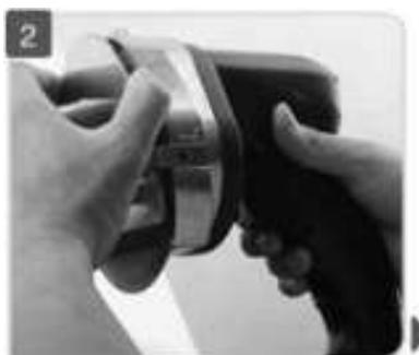
**Снимите предохранитель ножа**
