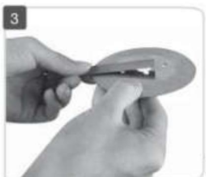
Снимите заусенцы с передней части режущей кромки.
