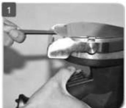
Заточите дисковый нож. Процесс заточки должен длиться примерно 1 – 2 секунды и должен выполняться под углом, максимально приближающимся к развернутому углу 180 °, с нижней части.
