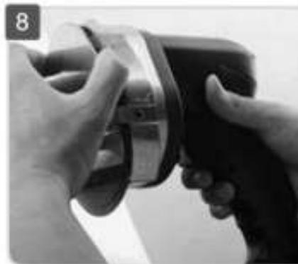
8. Закрепите предохранитель ножа и стопорный винт.
