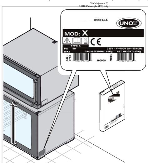
Прежде чем подключить устройство к электричеству, убедитесь, что характеристики источника питания соответствуют данным, указанным на шильде устройства.
