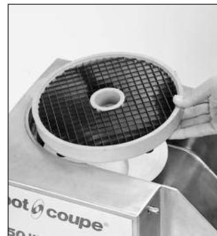
Установите затем соответствующий диск-измельчитель (диск с прямым лезвием) и прокрутите его в направлении часовой стрелки, чтобы проверить правильность его установки.
