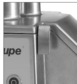
Приподнимите головку овощерезки, наклоняя ее назад, чтобы высвободить емкость.
