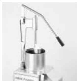
4) Установите воронку с рычагом на блок двигателя.
