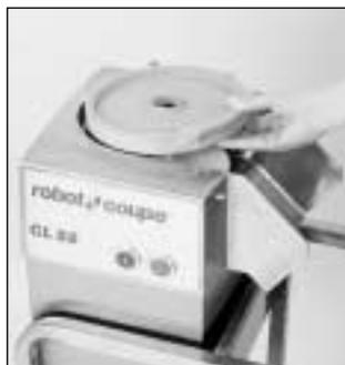
Установите затем соответствующий диск ломтики и убедитесь, что он установлен правильно, поворачивая его в направлении часовой стрелки.
