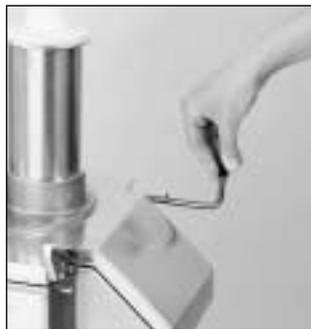
3) Зафиксируйте смеситель винтом на валу двигателя.
