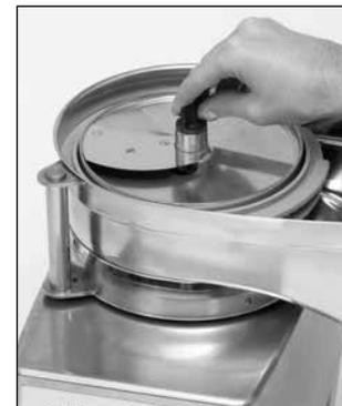
Установите затем соответствующий диск-измельчитель и завинтите крыльчатую гайку на валу двигателя для блокировки диска-измельчителя диск-измельчитель.
