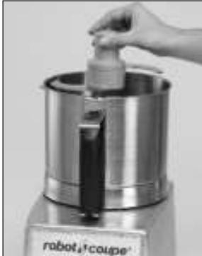
4) Установите крышку на емкость и поворачивайте ее вправо до полной блокировки.
