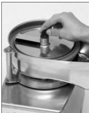
Установите затем соответствующий диск ломтики и зафиксируйте его винтом на валу двигателя.
