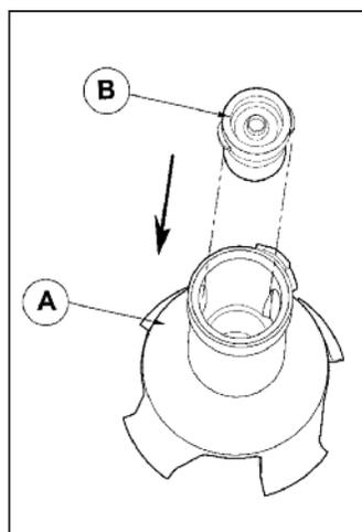
Установите проушины уплотнительного блока ② вровень с канавками насадки ①. Поверните уплотнительный блок рукой в направлении, указанном стрелкой, а затем закрепите его на насадке с помощью инструмента для снятия ножа.
