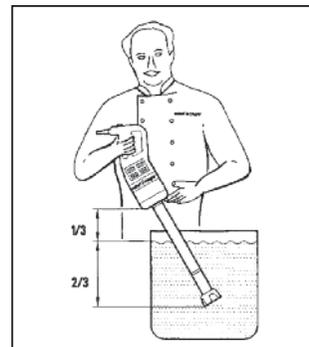
Можно также опереть аппарат на край кастрюли, слегка наклонив его и следя за тем, чтобы насадка не касалась дна рабочей емкости.
